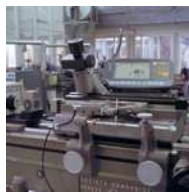
Application: TT 80 with a SIP (Société gene- voise d'instruments de physique) high preci- sion measuring bench
